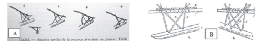
Figure 15. Attaches du balancier aux traverses.
